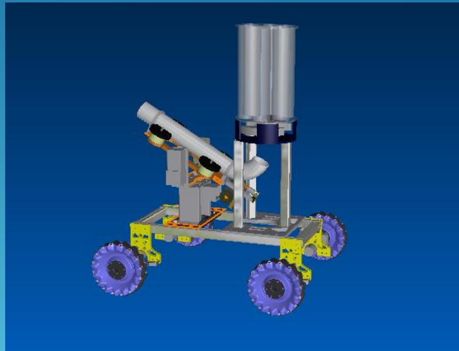
俯仰与左右云台控制，具精确至**0.01度**，且每一次转动都会自锁定位，避免了云台在发弹中失稳抖动
