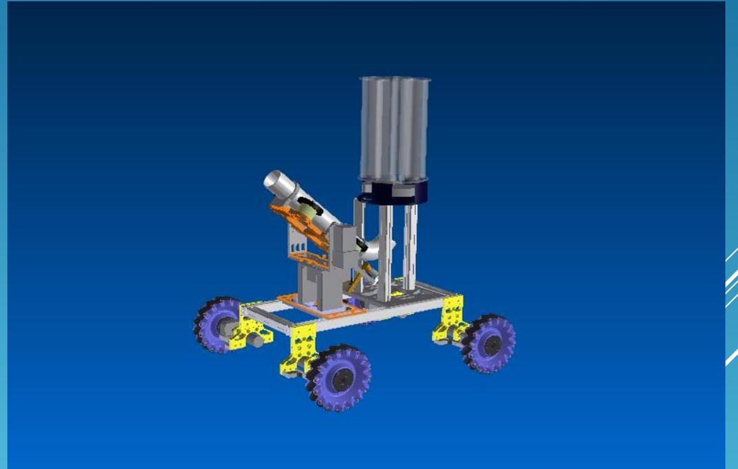
大仰角远程投弹，双级加速，最远射程30m
